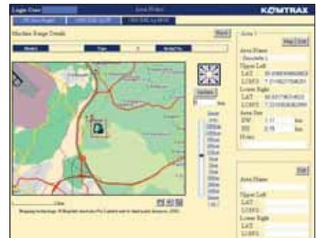
*Sécurité supplémentaire – Le «dispositif actionné à distance pour le verrouillage des engins» vous permet de programmer les heures pendant lesquelles vos machines peuvent travailler. Avec la limite géographique «géo-fence», KOMTRAX™ vous envoie un message en ligne pour vous indiquer que votre machine se trouve hors des limites de la zone que vous avez fixée.*
