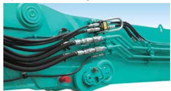
Couplage hydraulique latéral à hauteur d'homme.
