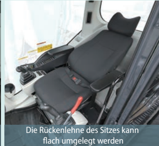
Die Sitzfederung absorbiert Vibrationen
