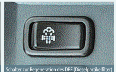
Schalter zur Regeneration des DPF (Dieselpartikelfilter)
