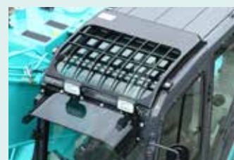
La protezione del tettuccio (livello II) è una dotazione standard.
