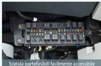
Scatola portafusibili facilmente accessibile
