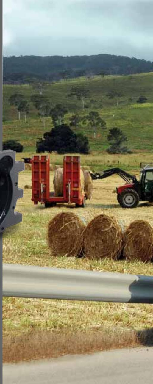
constant, en modifiant automatiquement le régime moteur en fonction de la charge. Lorsque la charge tractée est lourde, par exemple, après la phase de démarrage à un régime élevé, le régime moteur baisse automatiquement: la vitesse d'avancement réglée se maintient ainsi, avec, par conséquent, une baisse de la consommation.
