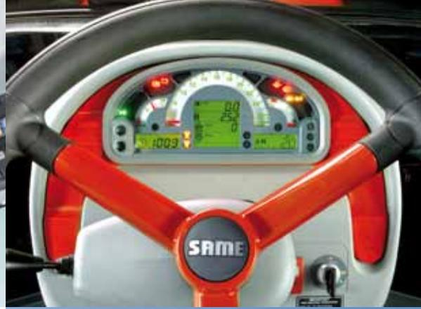
La vitesse d'avancement du tracteur, le régime de rotation de la PdF, les heures de travail et la distance parcourue sont affichés en temps réel pour permettre une rapide analyse du travail accompli. L'accoudoir multifonctions, dérivé des gammes de haute puissance, permet de contrôler les fonctions principales des Silver<sup>3</sup> de manière ergonomique et intuitive.
