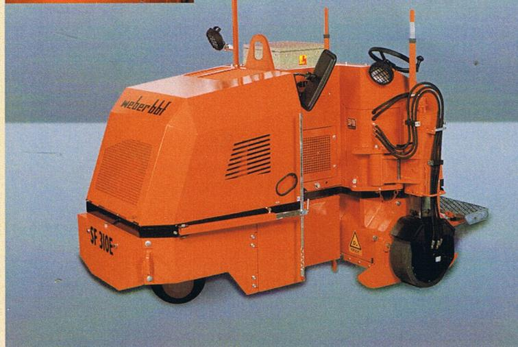
Leichte, elektrisch angetriebene Fräse mit Allradantrieb und hydraulischer Differenzialsperre. Ideal für den Einsatz bei Innenarbeiten in Beton oder Asphalt.
