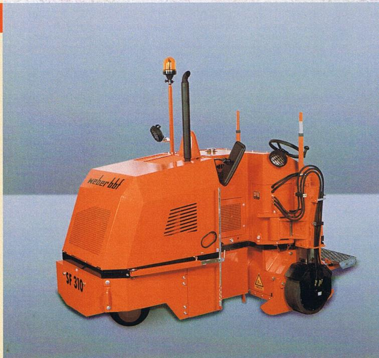
Mit 300 mm oder 350 mm Arbeitsbreite und geringen Außenmaßen ist die SF310 wendig und vielseitig einsetzbar für Asphalt- u. Betonarbeiten.
