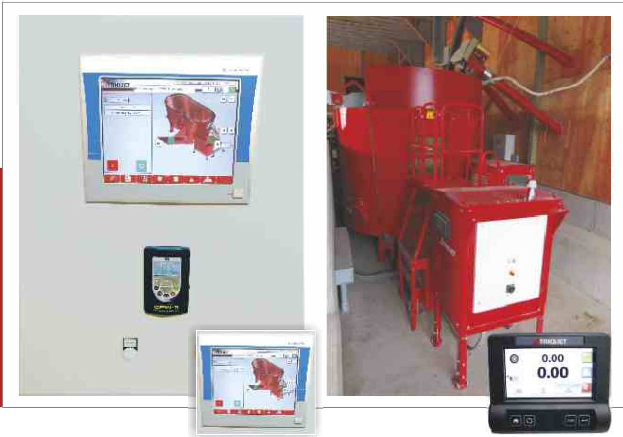
Draadloze afstandsbediening met touch screen en gewichtsindicatie.
