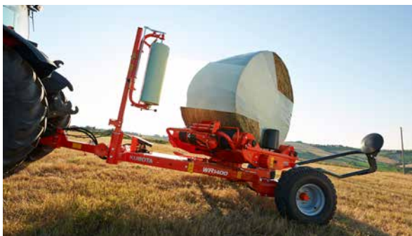
La conception basse de la machine assure un déchargement rapide et en douceur de la balle.
