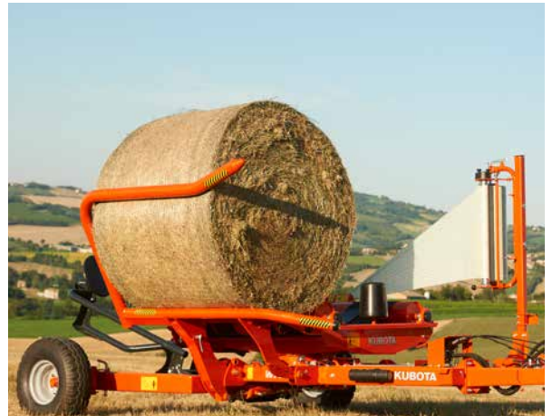
Le bras de chargement à commande hydraulique et la faible hauteur de chargement permettent un transfert rapide des balles du bras sur la table d'enrubannage.
