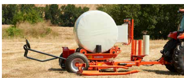
Le bras de chargement réglable permet à la balle d'être ramassée et chargée en mouvement.
