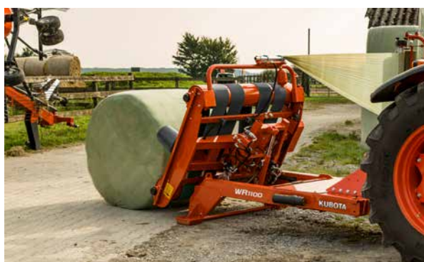
Capable de recevoir des balles rondes jusqu'à 1200 kg.
