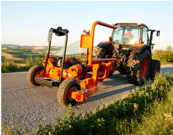
Le bras de chargement est complètement abaissé pour soulever la roue du sol et faciliter le passage du travail au transport.
