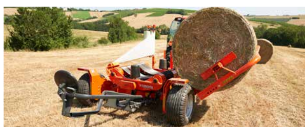
La faible hauteur de levage permet un transfert rapide de la balle du bras sur la table tournante.
