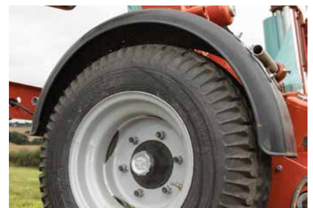
Des garde-boue sont disponibles évitant l'accumulation de terre sur le coupe film lors des déplacements sur des sols humides.
