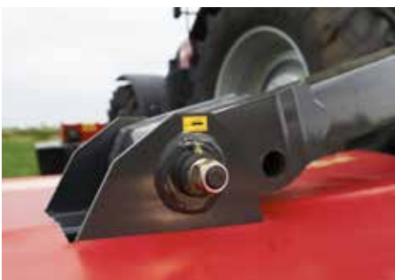
Dos posiciones de montaje de las unidades de corte. Óptimo solapamiento.
