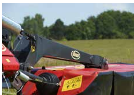
Suspensión pendular centralizada con perfecto seguimiento del terreno.
