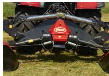
Muelles de regulación de presión.
