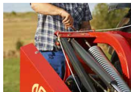
Muelles de compensación de presión sobre el terreno con fácil regulación.
