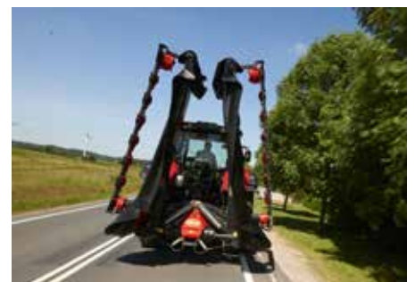
Plegado vertical en transporte. Excelente reparto de pesos.
