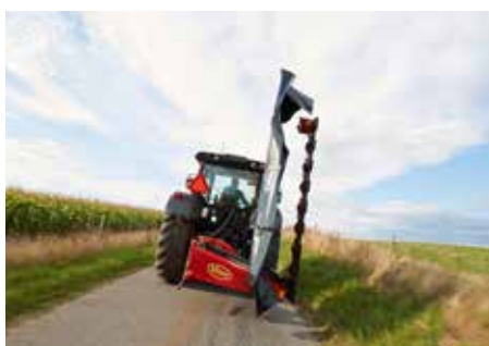
Plegado vertical en transporte. Excelente reparto de pesos.
