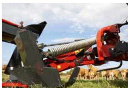
Acoplamiento lateral de la unidad de siega al cabezal de la máquina.
