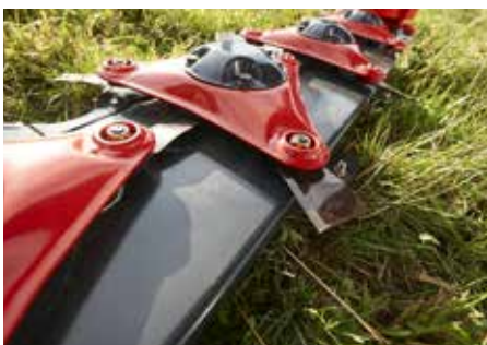
Barra de corte EXTRA con discos triangulares.
