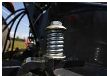
Breack-away: Sistema de seguridad non-stop.
