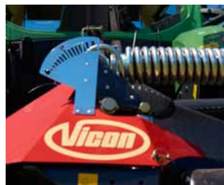
W opcji dostępna jest hydrauliczna regulacja siły nacisku na podłoże ustawiana z kabiny ciągnika.
