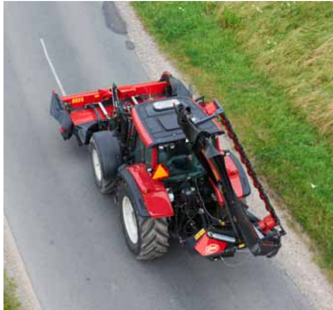
Pozycja transportowa pod kątem 125° zapewnia optymalne rozłożenie wagi.
