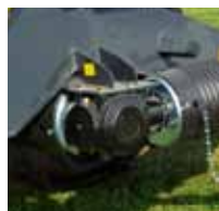
Kosiarka przystosowana jest do pracy z prędkością 540 lub 1000 obr/min na WOM.
