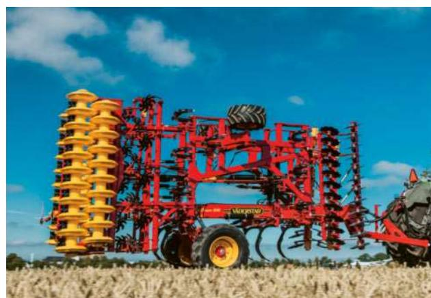
TopDown 300-700 se skládá na přepravní šířku 3 metry, zatímco širší TopDown 900 na 5 metrů.
