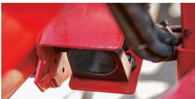
Přesné řízení radarovou jednotkou
