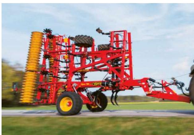
Uprostřed stroje umístěná nosná kola usnadňují přepravu stroje Opus a poskytují mu malý poloměr otáčení na souvratích.
