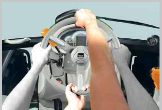
Il sistema di sterzata rapida SDD. Dimezza le rotazioni del volante, raddoppia la forza sterzante.
