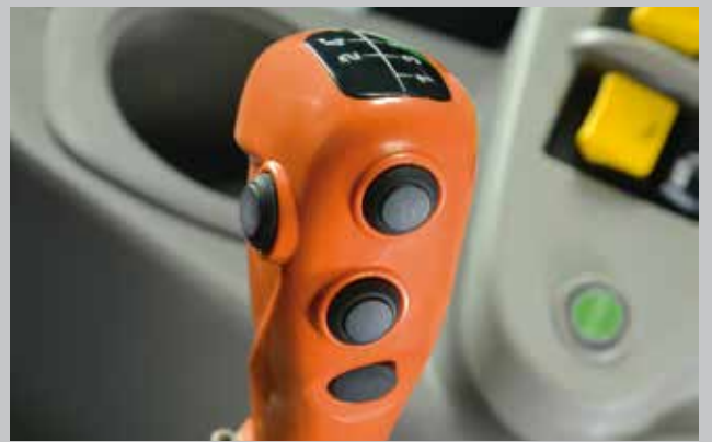
ComfortClutch e Powershift. Cambiare marcia con la semplice pressione di un pulsante e senza azionare la frizione.
