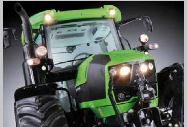
Per una visibilità ottimale in presenza di condizioni atmosferiche sfavorevoli. Otto fari di lavoro posti sul tetto e sui montanti laterali. Due fari di lavoro nel cofano.
