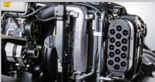
... l'impianto di raffreddamento e i radiatori sono facili da pulire.
