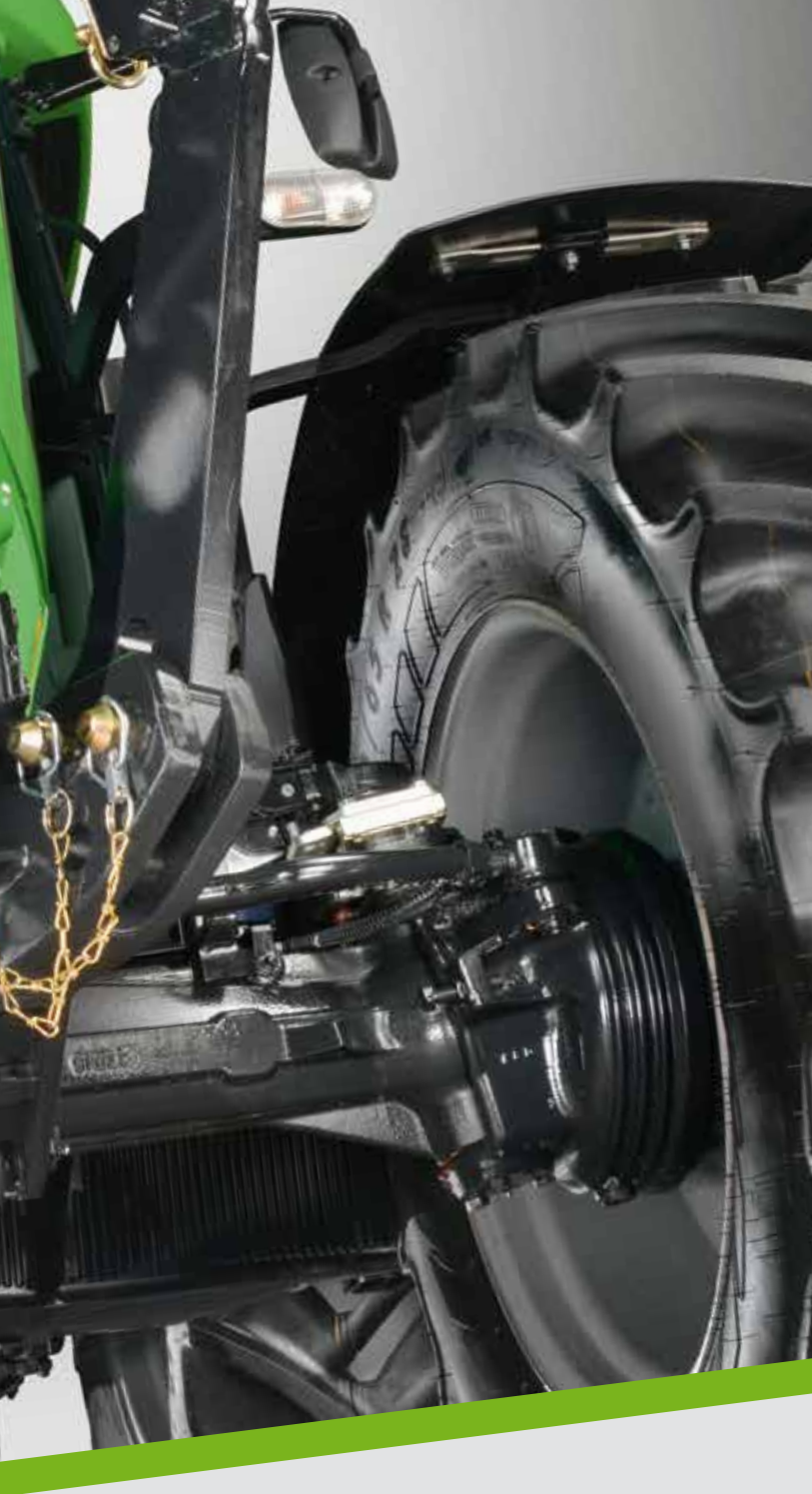
Un concetto di sicurezza unico di DEUTZ-FAHR. Freni a disco separati con raffreddamento a olio nel ponte anteriore.
