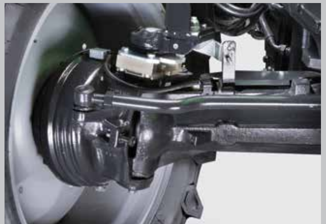
Un concetto di sicurezza unico di DEUTZ-FAHR. Freni a disco separati con raffreddamento a olio nel ponte anteriore.
