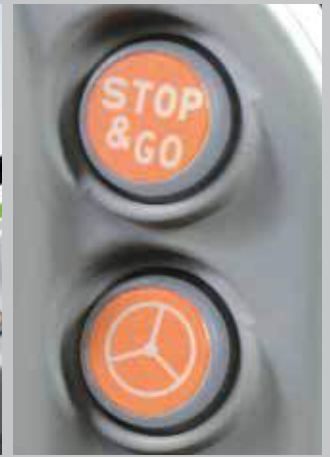
Il joystick del caricatore frontale con i pulsanti Powershift, Stop&Go, sistema di sterzata rapida SDD...
