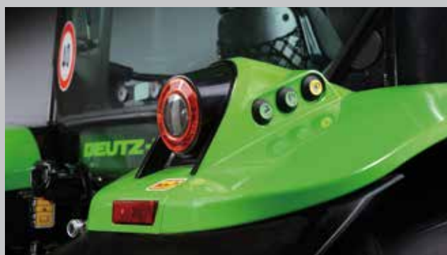
Comandi della presa di forza esterna e del sollevatore per un rapido montaggio e funzionamento dell'attrezzatura.
