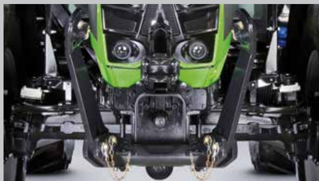
Sollevatore anteriore e presa di forza. Capacità di sollevamento di 2100 kg e PTO 1000.
