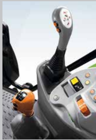
Il joystick del caricatore frontale con i pulsanti Powershift, Stop&Go, sistema di sterzata rapida SDD...
