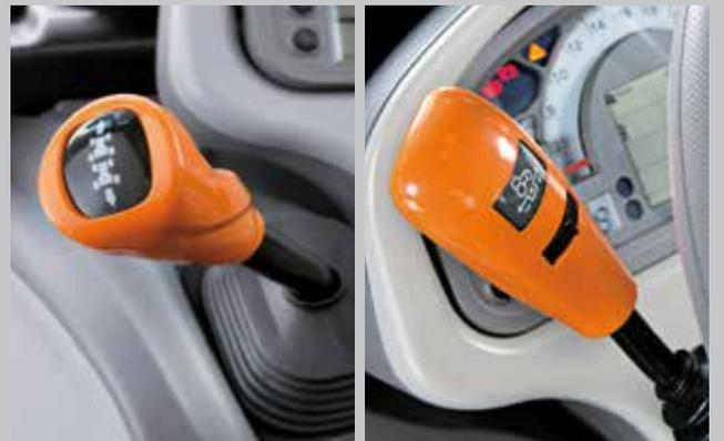
Inverseur mécanique ou Powershuttle à cinq configurations réglables – à vous de décider.
