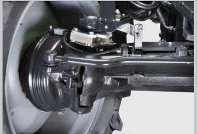
Un concept de sécurité unique conçu par DEUTZ-FAHR. Freins à disque séparés refroidis à l'huile sur le pont avant.
