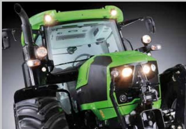
Pour une visibilité optimale en cas de mauvaises conditions météorologiques. Huit phares de travail sur le toit et les montants latéraux. Deux phares de travail sur le capot.
