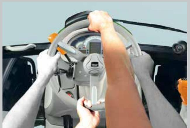
Système de direction rapide SDD. Rotations du volant divisées par deux, puissance de direction doublée.
