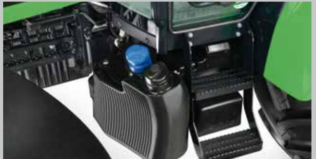
Un réservoir à carburant contenant jusqu'à 145 litres et 10 litres d'AdBlue permettent de longues périodes de travail. (en fonction du modèle)
