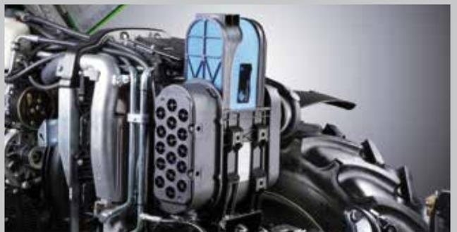
Le filtre à air PowerCore supporte l'efficacité du moteur...
