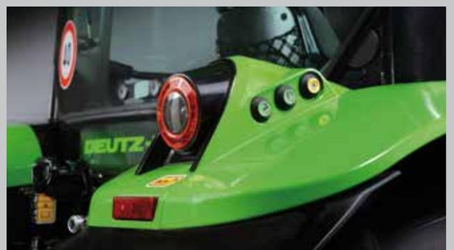
Commandes extérieures de relevage arrière et PDF pour l'installation directe des outils.
