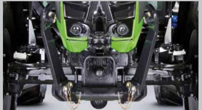
Relevage avant et PDF. Capacité de relevage de 2 100 kg et PDF 1 000.
