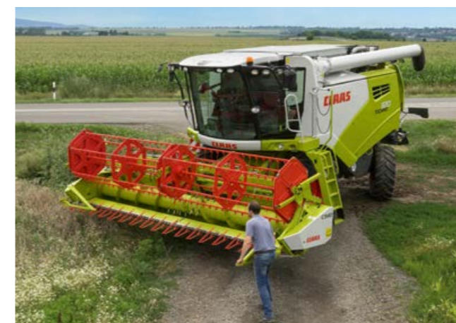
Składane rozdzielacze łań
