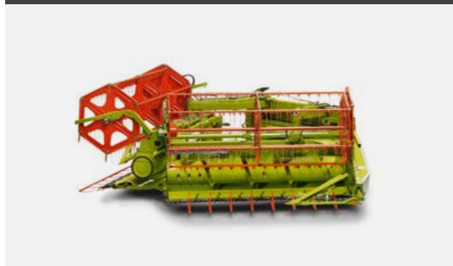
Składany przyrząd żniwny
