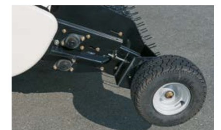
Koła kopiujące ograniczają głębokość.
