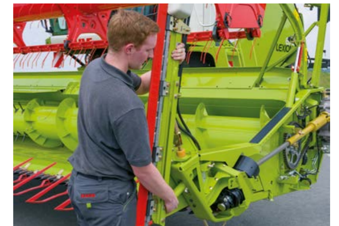
Montaż kosi do rzepaku poprzez szybkozłącza.
