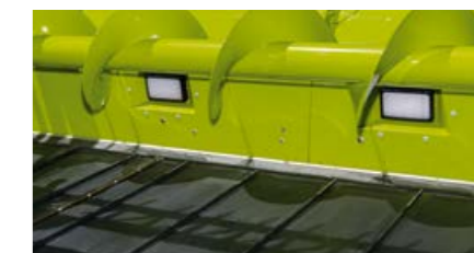
Silne reflektory robocze zapewniają doskonałe oświetlenie przyrządu żniwnego i koryta.
