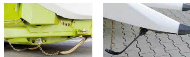
Pałki kopiujące rejestrują pozycję przyrządu roboczego dla AUTO CONTOUR i CONTOUR.
