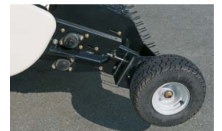
Tastwielen zorgen voor de dieptebe grenzing van het oogstmateriaal
