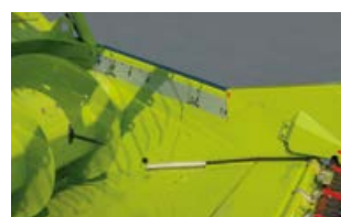
Perfekte weergave van de positie van de maaitafel vanuit de cabine.
