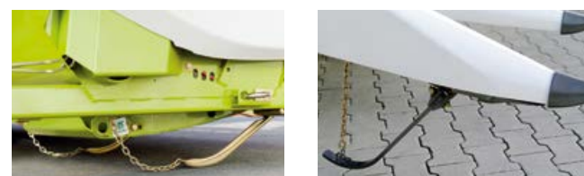
Tastbeugels registreren de positie van het voorzetstuk voor AUTO CONTOUR en CONTOUR
