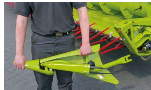
Sneller en eenvoudiger de halmverdelers vervangen.
