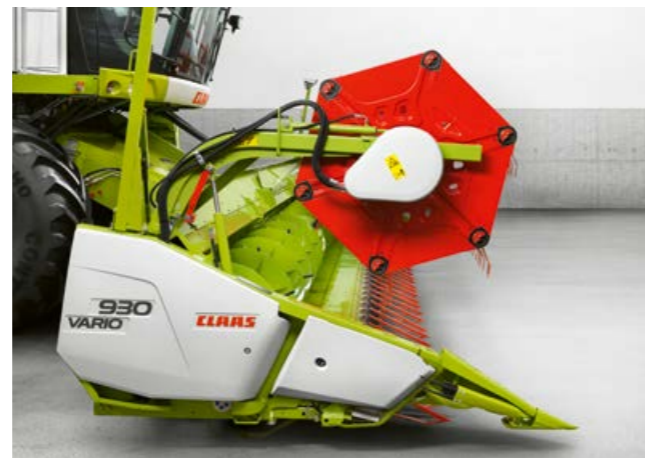
Schneidwerkstisch eingefahren – Getreide (– 100 mm).
