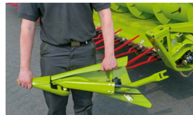
Schneller und einfacher Halmtellerwechsel.
