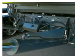
2-Wege-Vorsatzzylinder regeln präzise den Auflagedruck.
