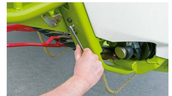
Einfache Höhenverstellung des Halmtellers mit dem Klappenschlüssel.
