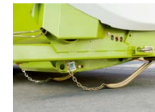
Tastbügel erfassen die Position des Vorsatzgerätes für AUTO CONTOUR und CONTOUR.
