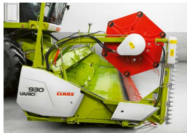
Schneidwerkstisch ausgefahren – mit Rapsmesser (+ 600 mm).
