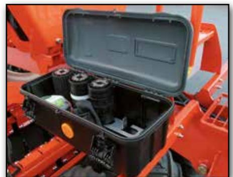
Abdrehsack und Waage befinden sich griffbereit in der vor Staub und Wasser geschützten Werkzeugkiste.
