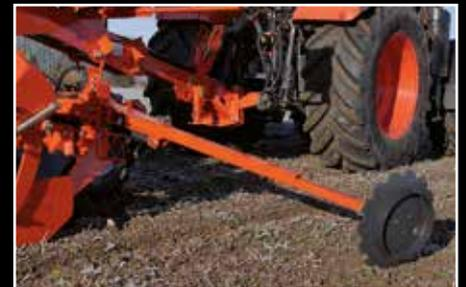
Hydraulisch klappbarer Spuranreißer mit gezackter Scheibe
