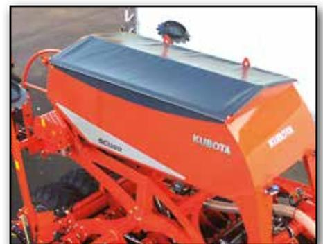
*Eine komplett zu schließende Tankabdeckplane schützt das Saatgut vor Staub und Wasser.*
