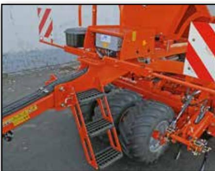
*Beladestufen und eine Plattform ermöglichen einen sicheren Zugang.*
