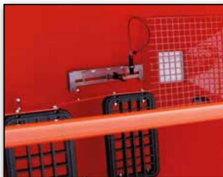
*Stufen innerhalb des Tanks sorgen für sicheren Zugang, um z.B. den Füllstandssensor einzustellen.*
