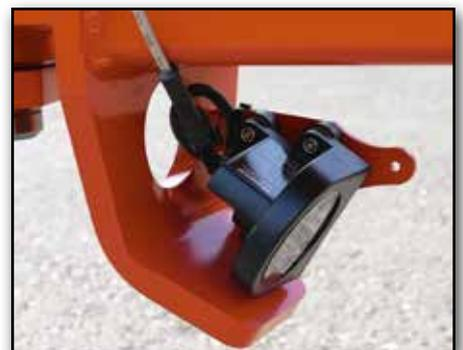
Der Radar-Geschwindigkeitssensor nimmt die Geschwindigkeit auf und passt die Ausbringmenge zeitgenau entsprechend an.
