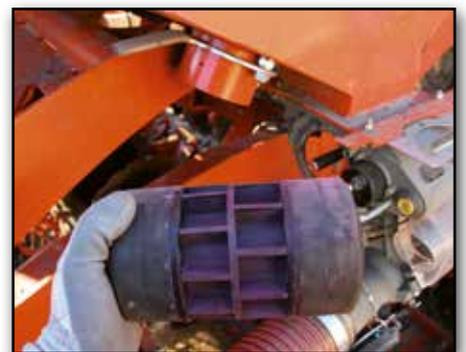
*Das Dosiergerät ist leicht zugänglich. Beim Rotorwechsel wird kein Werkzeug benötigt.*
