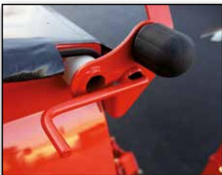
Mit dem einfachen System zur Verriegelung der Abdeckung kann der Tank einfach und schnell geöffnet und geschlossen werden.
