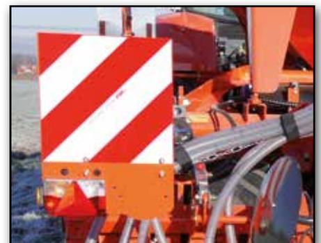
Die Maschine wird über die Unterlenker des Schleppers (Kat. III) gekoppelt. Um der StVZO gerecht zu werden, ist die Maschine mit einem Zweikreis-Bremssystem (optional hydraulisch) sowie mit Beleuchtung und Warntafeln ausgestattet.
