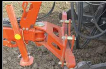
Unterlenker-Anhängung Kat. 3 (965 mm)
