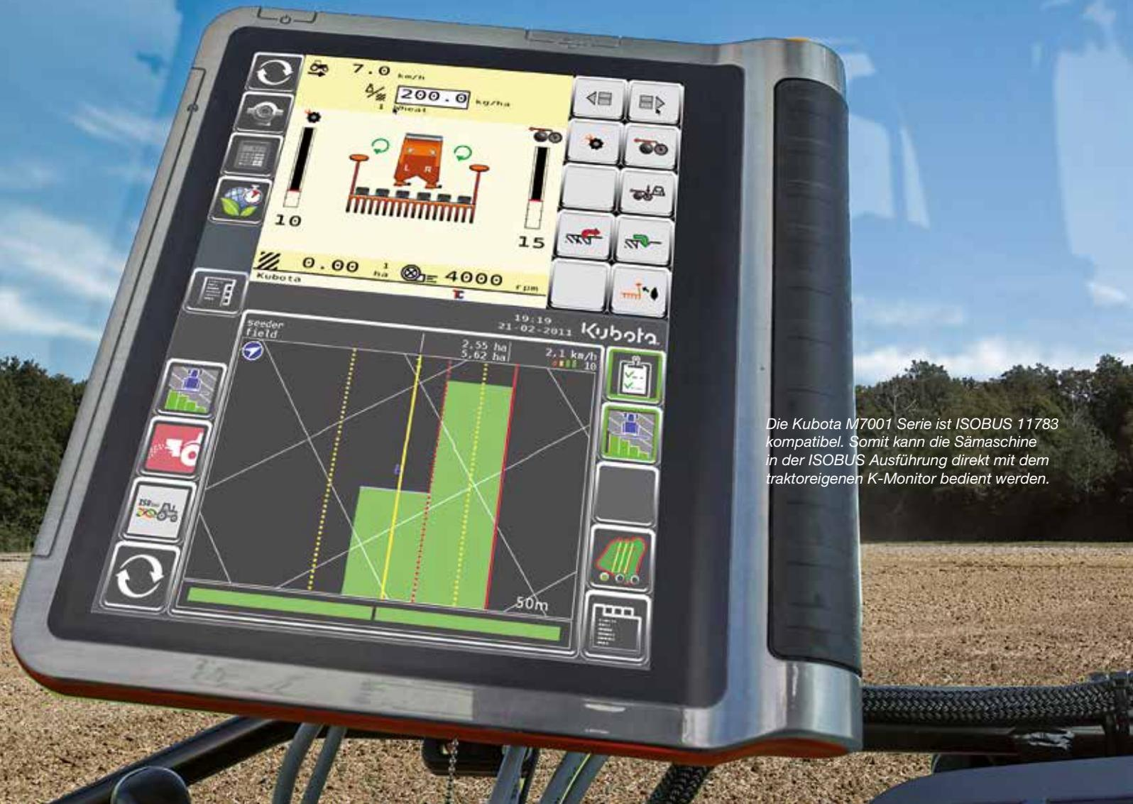
Die Kubota M7001 Serie ist ISOBUS 11783 kompatibel. Somit kann die Sämaschine in der ISOBUS Ausführung direkt mit dem traktoreigenen K-Monitor bedient werden.
