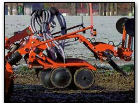
*Kein Überlappen am Vorgewende - um eine einheitliche Tiefenkontrolle zu gewährleisten, hebt zunächst das Scheibeneggenresegment dann der Frontreifenpacker und schließlich die Scharschiene*
