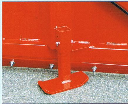
Die Schlepsschuhe sind höhen verstellbar und die Verschleißleiste hat 2 Verschleißseiten.
