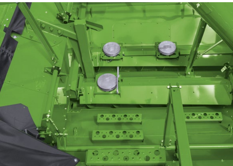
Drie sensoren meten het gewicht van het graan.
