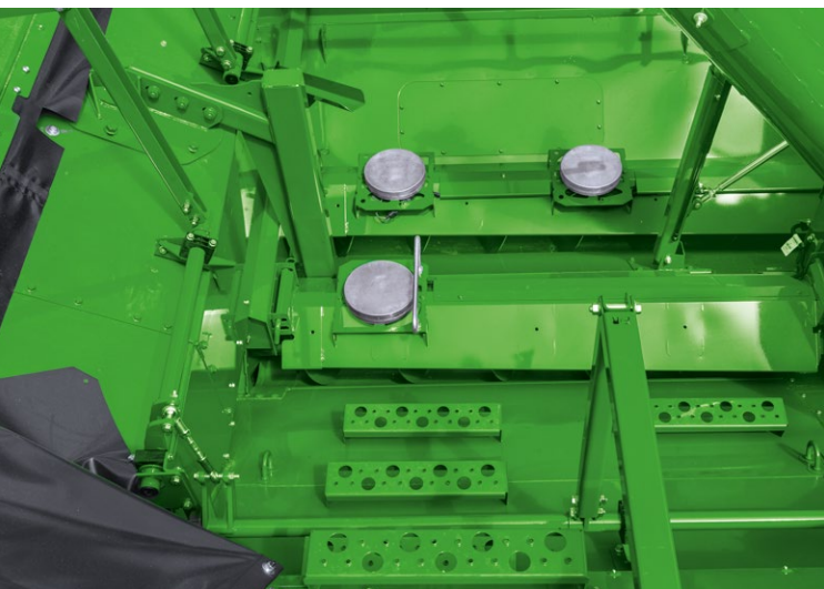
Trois capteurs déterminent le poids de la trémie.
