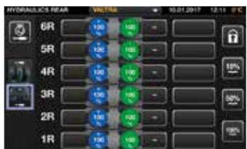
Możliwość sterowania elementami układu hydraulicznego, w tym zaworami hydraulicznymi (przednimi i tylnymi), podnośnikami (przednim i tylnymi) oraz ładowaczem czołowym.
