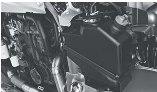
Serbatoio AdBlue per il post-trattamento dei gas di scarico
