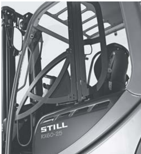
Sistema de retención del conductor IWS
