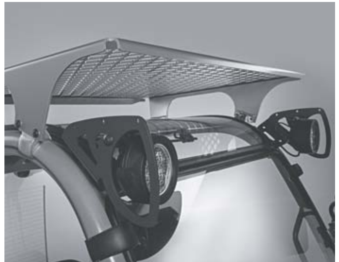
Protección adicional contra la caída de elementos de la carga
