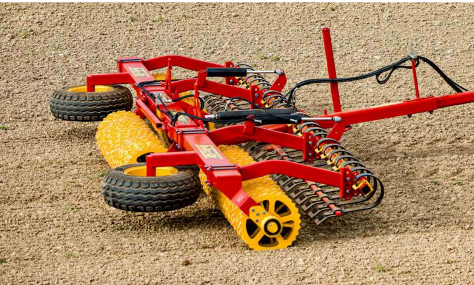
У Rollex мощная рама, закаленные втулки и высококачественные кольца катка, гарантирующие длительный срок службы машины. Оси катков изготовлены из легированной стали высочайшего качества. Для снижения износа колец при работе на поле в секциях катков Rollex используются уникальные пружинные шайбы.
