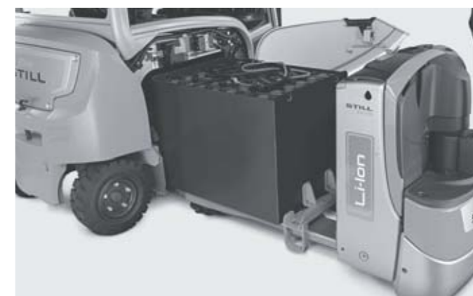
Замена аккумуляторных батарей производится с помощью электротележек
