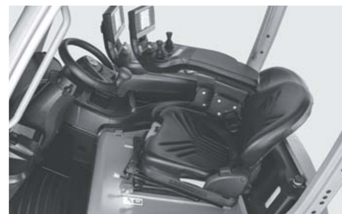
Поворотное сиденье, облегчающее оператору движение задним ходом
