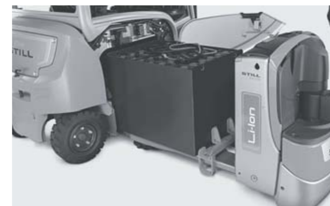
Výměna baterie pomocí elektrického vozíku
