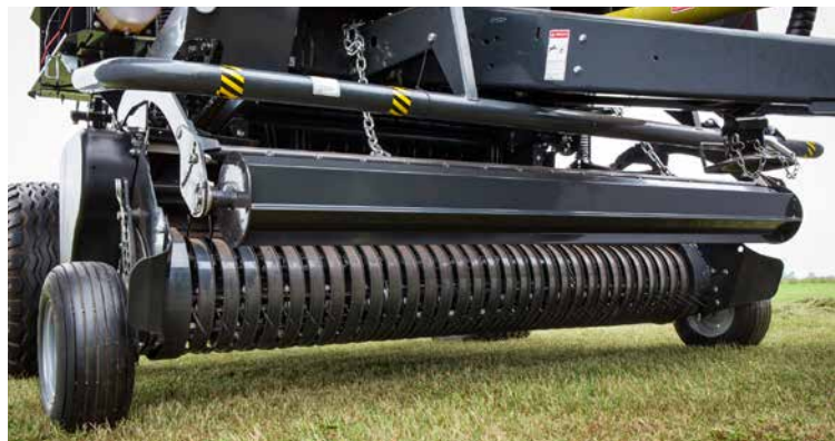
Rouleau de précompression à grand diamètre qui facilite le débit de récolte à un aménagement plus rapide.
