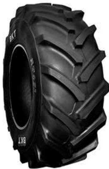
RT 851 est un pneu R-1 particulièrement conçu pour les tracteurs dans les applications sur pelouses. Le dessin spécial arrondi des pavés a été développé pour limiter tout éventuel dommage à la pelouse et aux plantes qui poussent, en modérant le compactage du sol. La robuste carcasse en nylon avec ceintures résistantes en polyester garantit une durabilité supérieure ainsi qu'une très longue vie du pneu. RT 851 offre également des propriétés d'auto-nettoyage exceptionnelles.
