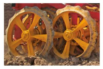
Gli anelli del packer sono montati in posizione sfalsata, minimizzando l'effetto di trascinamento e riducendo l'assorbimento di potenza.
