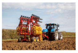
Il ripiegamento di Väderstad offre a RexiusTwin un basso centro di gravità e una buona manovrabilità nel trasporto, oltre a un eccellente adattamento al contorno sul campo.
