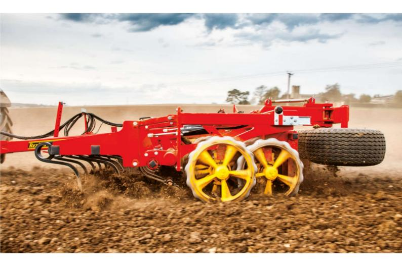
Il RexiusTwin taglia, frantuma, livella e compatta il terreno in un solo passaggio, preservando la struttura del terreno e creando una superficie resistente alle intemperie. Ne beneficerete di una grande capacità e di buone condizioni per la coltura a seguire.
