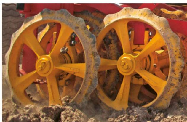
*Les billes du rouleau sont montés en position OffSet, ce qui réduit l'effet bulldozer et la force de traction nécessaire.*
