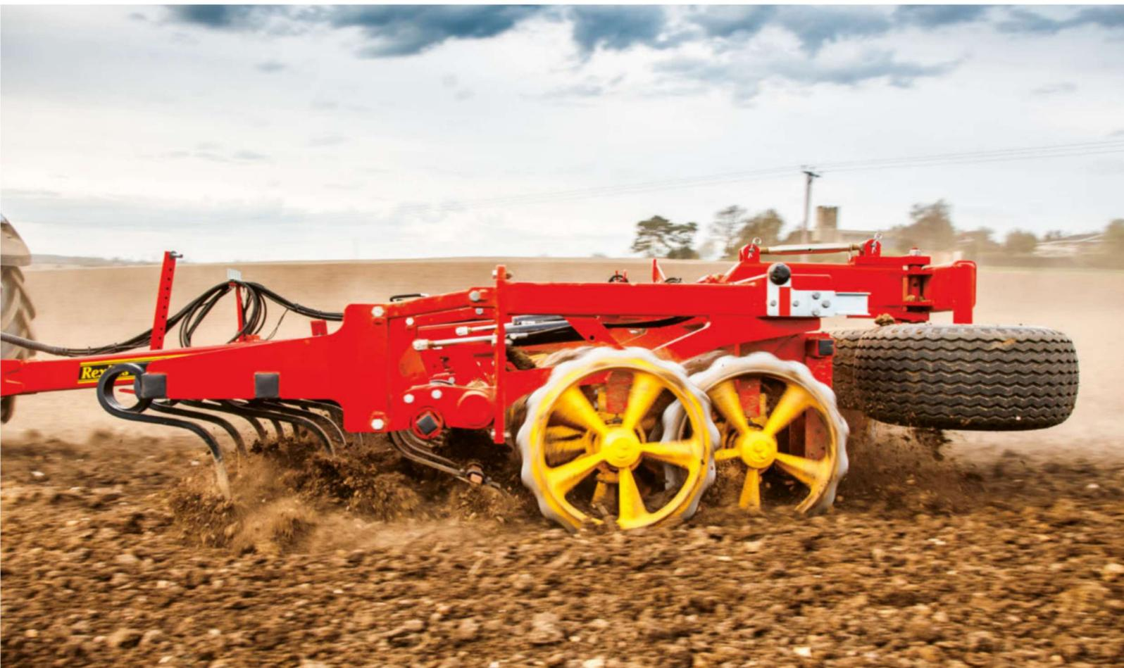
Le RexiusTwin coupe, broie, nivelle et consolide le sol en un seul passage tout en maintenant la structure du sol et en créant une surface perméable. Vous bénéficiez d'un grand débit de chantier et des meilleures conditions pour la culture à venir.
