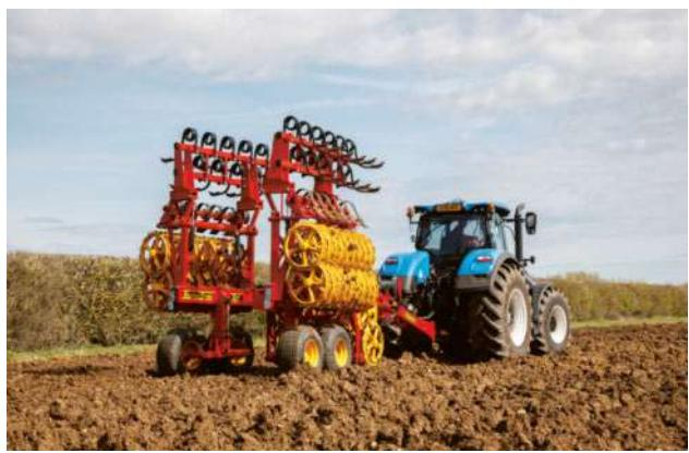
*Sklápění Väderstad poskytuje stroji RexiusTwin nízké těžiště a dobrou manévrovatelnost při přepravě jakož i vynikající kopírování profilu na poli.*
