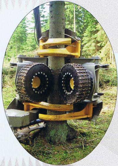
proportional, sie können individuell und je nach Baumart, Baumdurchmesser und Vorschubrichtung eingestellt werden. Dies sorgt für beste Voraussetzungen für ein gutes Entastungsergebnis und schonende Holzbehandlung. Ist das Aggregat mit einer Farbmarkierungsgerät (Zusatz-ausrüstung) ausgestattet, werden die Rohre des Pendelarms als Farbbehälter verwendet.
