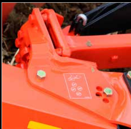
Prosta, mechaniczna zmiana szerokości roboczej w RM2000-RM2005. Regulacja każdego korpusa za pomocą jednej śruby.
