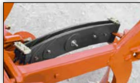
Podwójny resor z 14 piórami (1400 kg)
