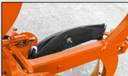
Resor HD z 9 piórami w zestawie (900 kg)
