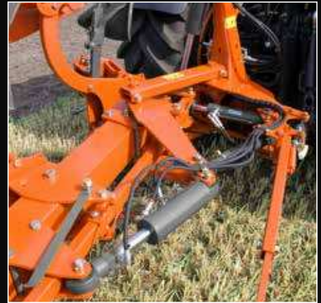
Variomat® am RM2000V-RM2005V. Parallelgestänge mit Memoryzylinder und hydraulischer Einstellung der Vorderfurche.
