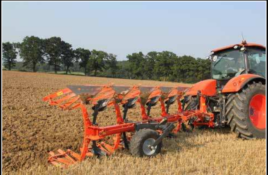
RM3000V: Scherbolzenpflug mit Variomat® System
