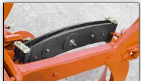
Doppeltes Federpaket mit 14 Blättern (1.400 kg)
