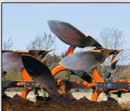
RM2005/RM2005V mit leistungsfähiger Blattfedersteinsicherung
