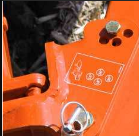
Einfache, stufenweise Einstellung der Arbeitsbreite bei RM2000-RM2005. Nur eine Schraube ist umzustecken.
