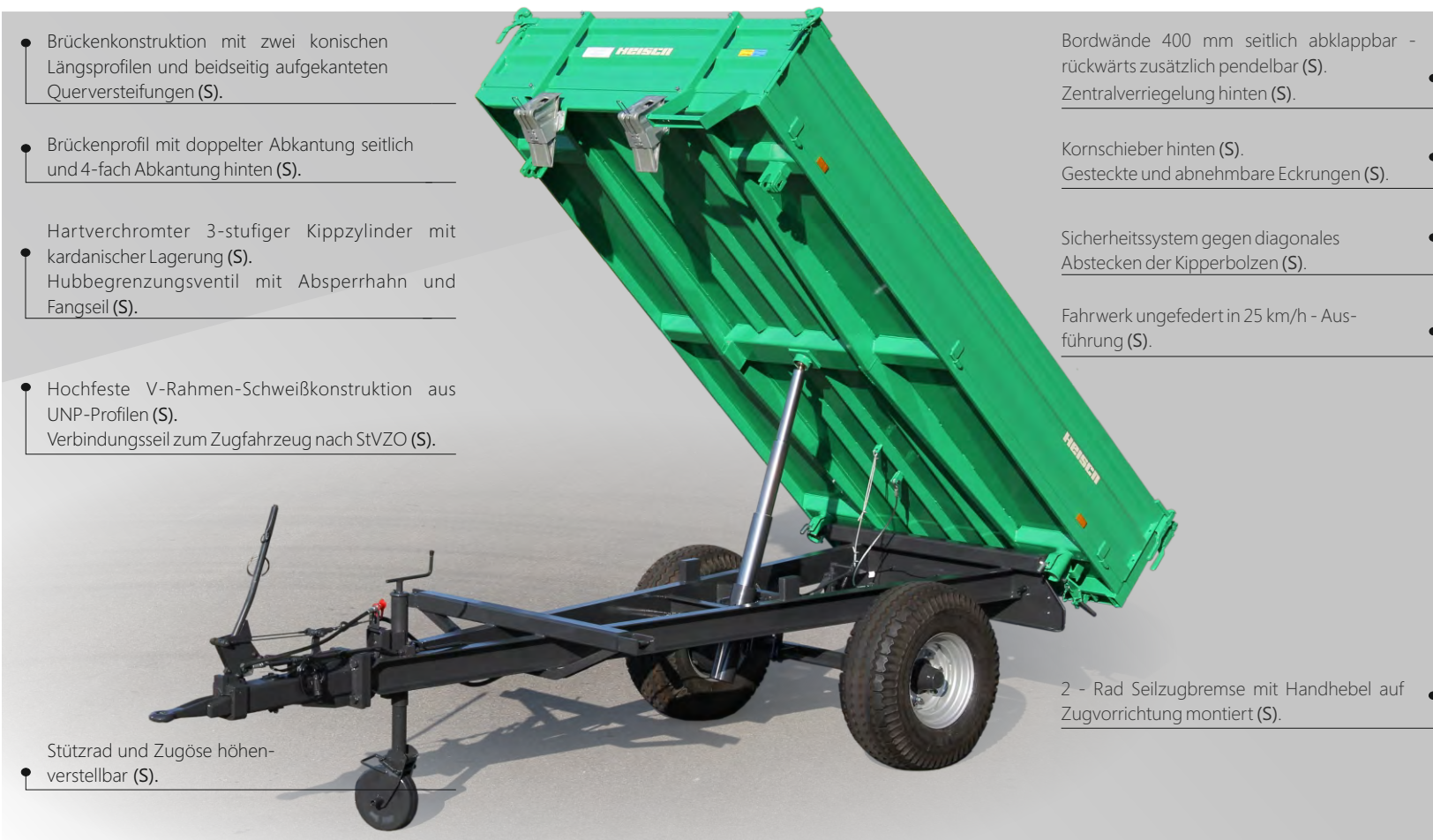
REDK - 30 mit selbstspannendem Komfortverschluss und Sicherheitsverriegelung (S)
