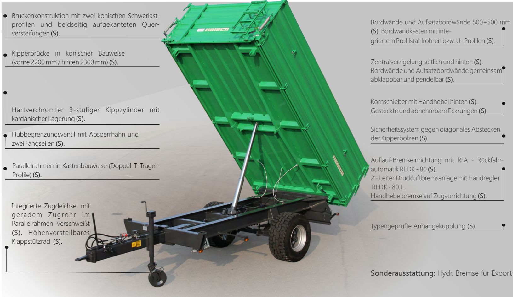
Bordwandversteifung aus hochfesten Profilrohren im seitlichen Bordwandkasten integriert bei den Fahrzeugen REDK-80 bis REDK-120 (S).
