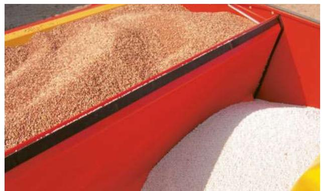
*Rapid 300-400C/S verfügt über einen schlagkräftigen Saatguttank. Bei den Kombimodellen lässt sich das Mengenverhältnis zwischen Saatgut und Dünger leicht verändern.*
