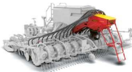
*Rapid A 400-800S und Rapid A 600-800C können mit BioDrill 360 ausgestattet werden. Die pneumatische BioDrill 360 ist mit dem elektrischen Dosiersystem Fenix II ausgestattet, das eine gleichmäßige Aussaat von Feinsämereien ab Aussaatmengen von 1 kg pro Hektar ermöglicht.*
