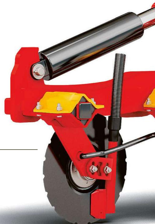
*Poměrem mezi secími kotouči a sadou pěchovacích kol se nastavuje hloubka setí a velmi vysoký přítlač secích botek zajišťuje, že se hloubka nikdy nezmenší. Tím Rapid zajišťuje trvale rovnoměrné vzcházení.*
