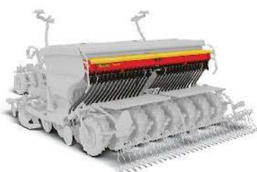
Rapid 300-400C/S může být vybaven strojem BioDrill 180-250. Má gravitační dávkovací systém s nemnoha pohyblivými díly, což v důsledku znamená minimální údržbu a dlouhou životnost.
