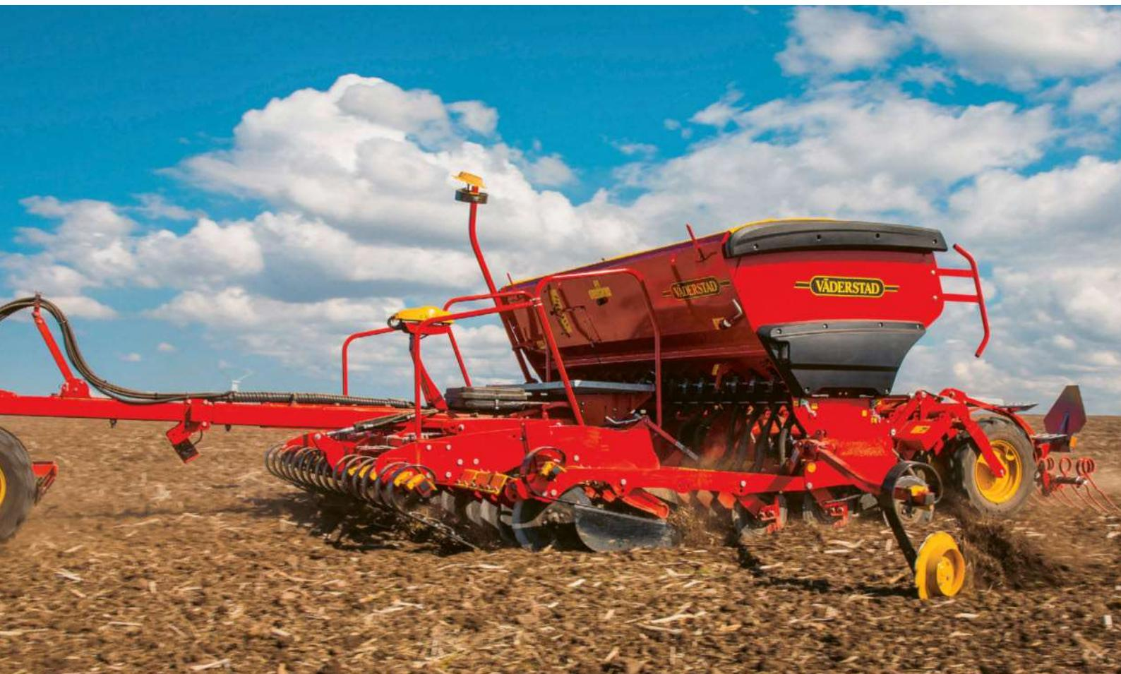
Díky své všeestrannosti si stroj poradí s řadou plodin, travinami a meziplodinami stejně jako s mikrogranuláty nebo kuličkami proti slimákům. Když je vybavený malým přídavným secím strojem BioDrill, přidává se další plodina.
