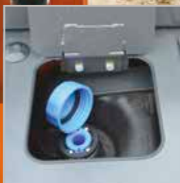
Depósito de reducción catalítica selectiva (SCR)
