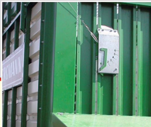
Для контроля за выгрузкой, на переднем борте расположен указатель угла открытия заднего борта.
