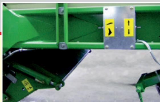
◀ Die seitliche Steuerung erhöht den Komfort beim Schneidwerk-Service.
