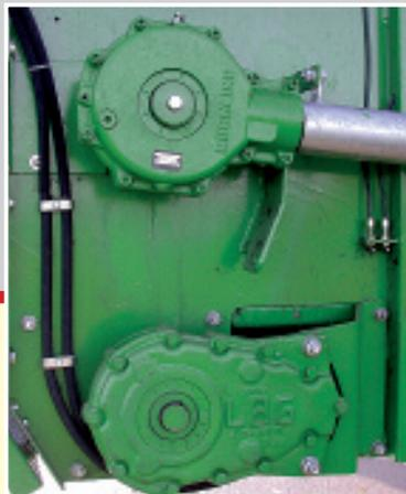
Der Walzenantrieb erfolgt mit einem Aufsteck-Winkelgetriebe. Der hydraulische Transportbodenantrieb ist reversierbar.
