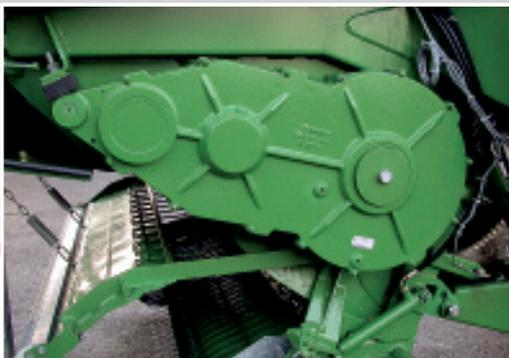
Das robuste, schwimmend aufgehängte Stirnradgetriebe als geschlossenes Ölbadgetriebe mit einem Wellendurchmesser von 90 mm ist für höchste Leistungen ausgelegt.
