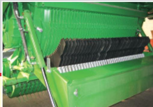
Die 35-mm-Kurzschnitteinrichtung garantiert einen optimalen Schnitt. Jedes der 41 Messer ist einzeln fremdkörpergesichert.
