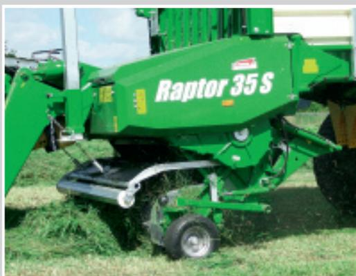
Optimaler Materialfluss von der 1,90 m breiten Pick-up mit Schwadrolle über den Rotor bis in den Laderaum.
