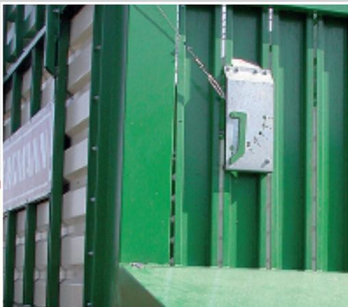
Für eine optimale Entladung ist an der Stirnseite eine Heckklappen-Stellungsanzeige montiert.
