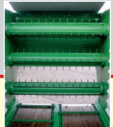
Der Raptor ist entweder ohne Dosierwalzen oder mit 2 bzw. 3 aggressiven Dosierwalzen erhältlich.
