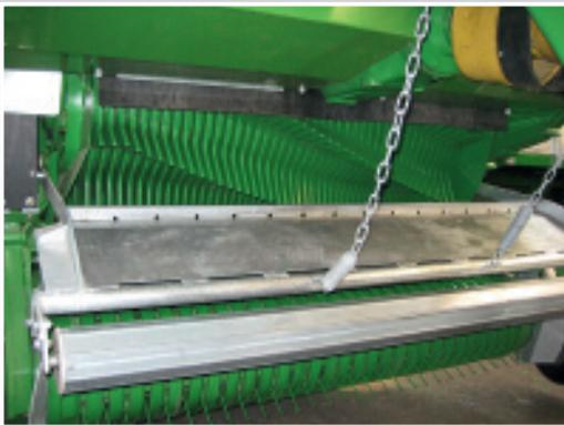
Der breite Rotor mit 12 mm breiten Zinken und 8 schraubenförmig angeordneten Zinkenreihen bürgt für hohe Ladeleistung und sorgt für einen futterschonenden Materialfluss.
