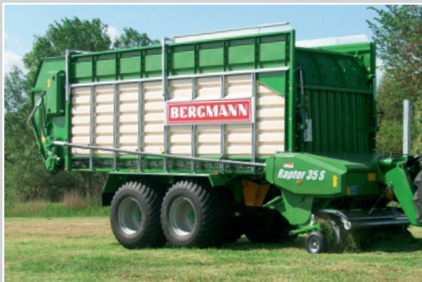
Der Raptor-Aufbau ist nach neuesten Gesichtspunkten konzipiert: Der Rahmen mit geschlossenem Ganzstahlaufbau und pulverbeschichteten, verzinkten Trapezblechprofilen sichert eine lange Nutzungsdauer.
