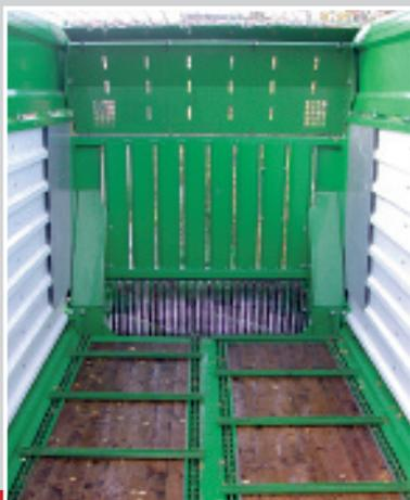
▲ Der Rotor mit breiten Zinken befüllt den großen Laderaum optimal. Der Kratzboden verfügt über 4 hochfeste Ketten (je 11 x 31 mm, 15 t / Kette).
