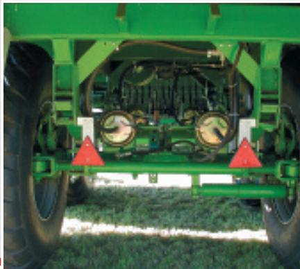
Sorgt für perfekten Stand auf dem Silo sowie stabilen Lauf im Feld und auf der Straße: 4-Feder-Tandemaggregat mit dreilagigen Parabelfedern und Nachlauflenkachse, hydraulisch sperrbar. Die Druckluftbremsanlage mit ALB-Regler ist serienmäßig.
