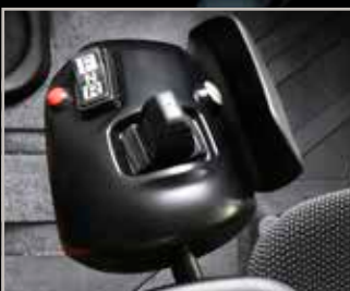
Direction par manette électro-proportionnelle
