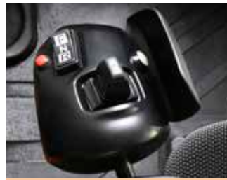
Direction par manette électro-proportionnelle
