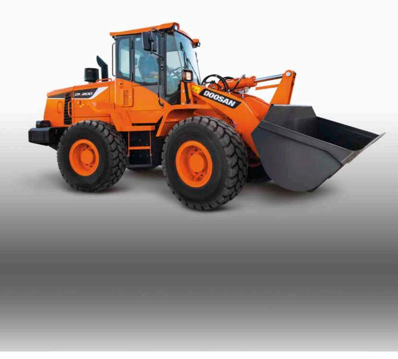
Potenza max: 142 HP Peso operativo: 11.640 kg Capacità benna: 1,9 m³
