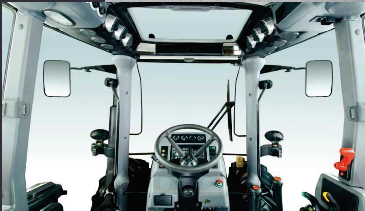
■ Auch das am Kabinenholm angebrachte Auspuffrohr trägt zur hervorragenden Sicht nach vorne bei.
