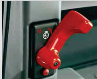
■ Vorwählhebel zum Ändern der Motordrehzahl am B-Holm. Speicherung einer Motordrehzahl nach Wunsch.
