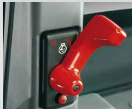
■ Palanca de mando para modificar el régimen del motor, situada en el montante intermedio de la cabina. Posibilidad de memorizar el régimen del motor.
