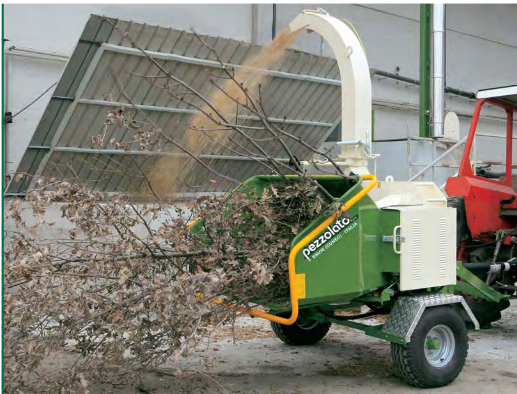
PZ 250 G montada en carro para baja velocidad, en acción. Esta versión está dotada, de serie, con enganche para tres puntos y pies de apoyo.
