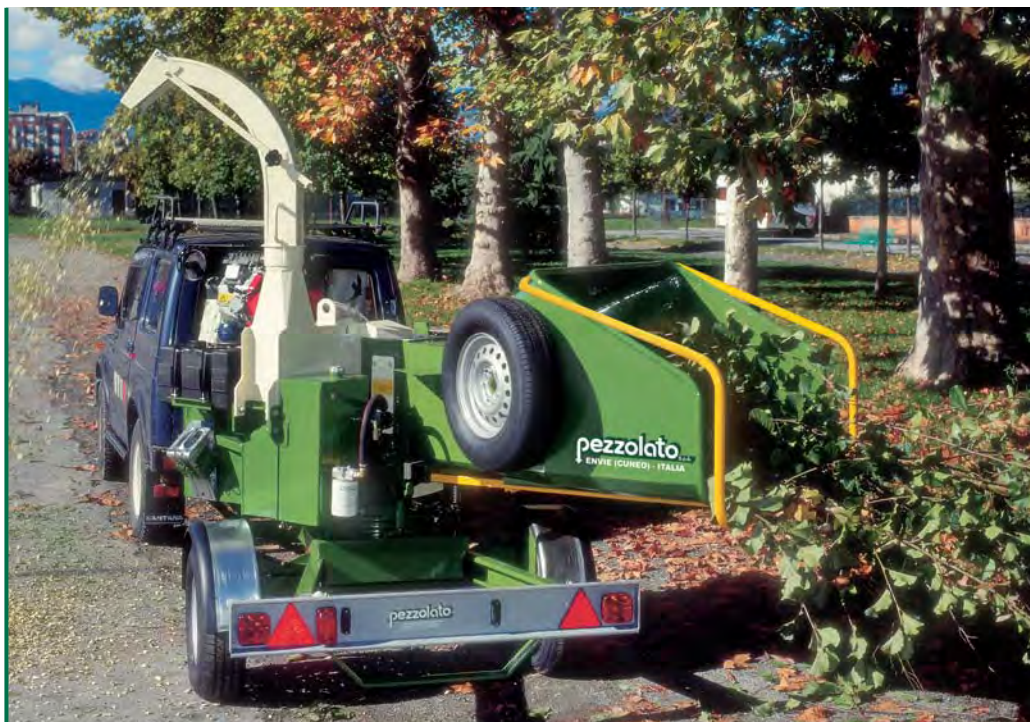
La versión PZ 150 MB en acción. Funciona con motor a gasolina de 20 Hp y está montada en carro para arrastre a 80 km/h. Está equipada con pivote giratorio que permite colocar la boca de carga para facilitar al máximo la entrada del material a triturar.
