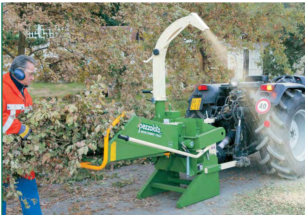
La versión PZ 100 G en acción, funciona con toma de fuerza y está dotada de enganche para el tercer punto del tractor.
