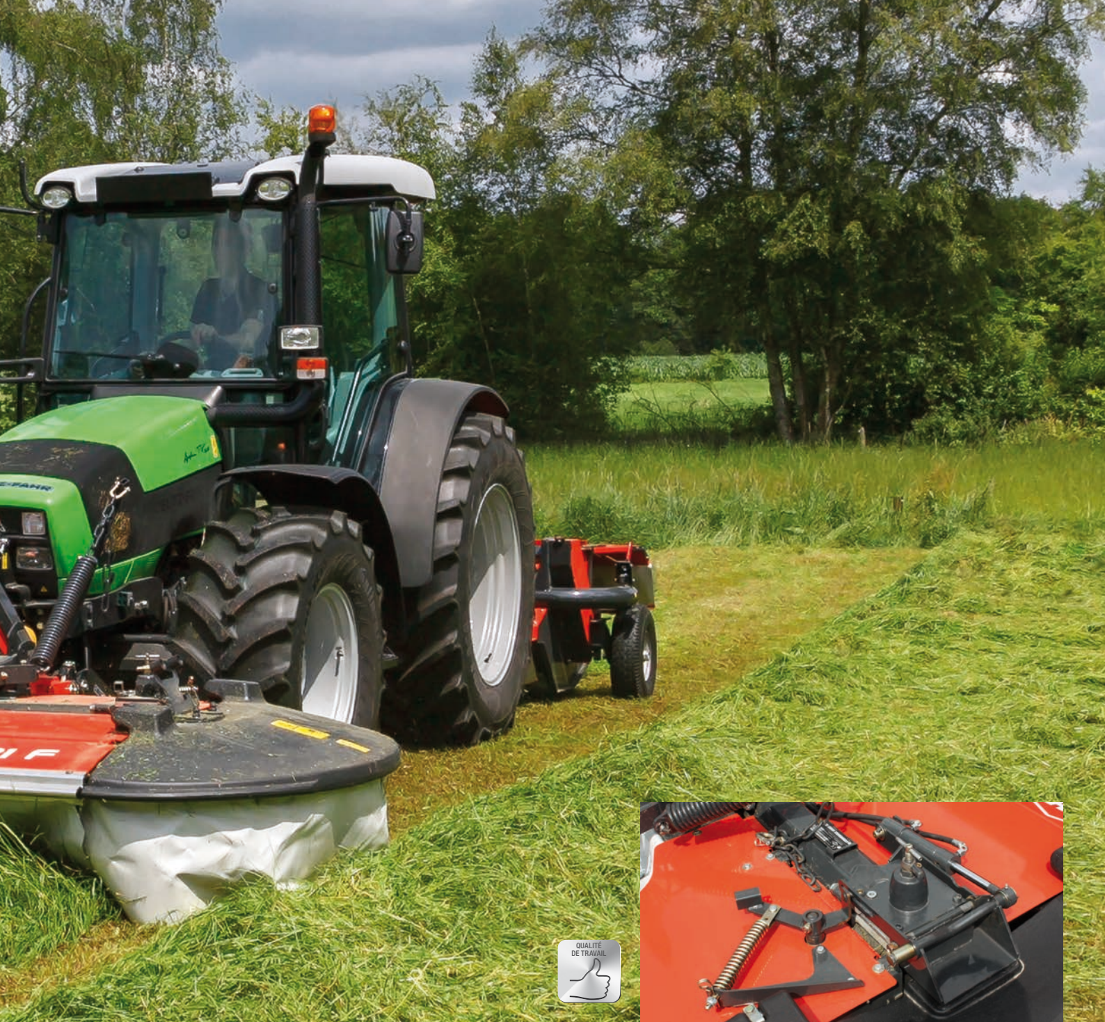
Système de repliage hydraulique pour les protections latérales
