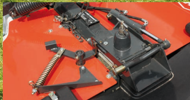
Système de repliage hydraulique pour les protections latérales
