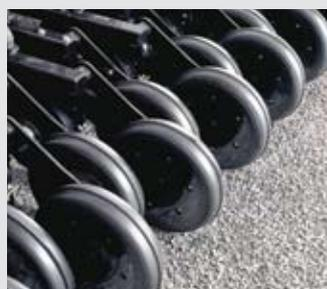
Breite Druckrollen (7,5 cm Breite) für leichte Böden führen das Schar exakt in der Tiefe und erzeugen einen idealen Bodenschluss
