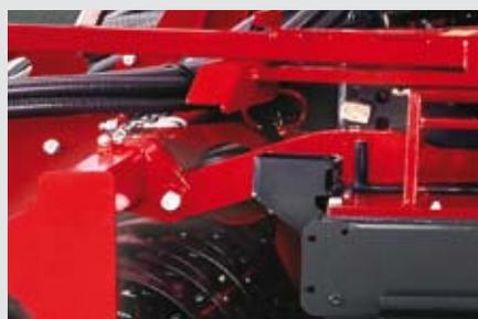
Tiefeneinstellung des Kreiselgrubbers mittels Steckbolzen
