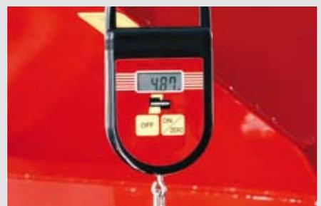
LCD-Waage zum exakten Bestimmen der Saatmenge
