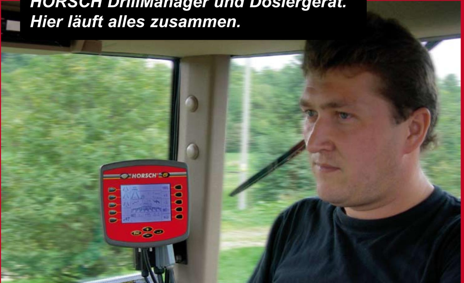
Der DrillManager ist die Steuereinheit der Pronto KE. Er steuert und kontrolliert sämtliche Funktionen der Sämaschine. Seine modulare Bauweise ermöglicht unterschiedliche Ausstattungsvarianten für jeden Maschinentyp.
