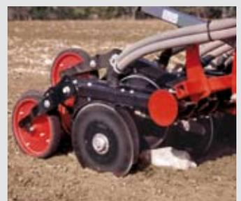
Mit maximalem Schardruck bleibt die Bewegungsfreiheit des TurboDisc-Schares ( $\pm 7,5$  cm) erhalten
