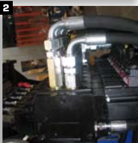
2 DISTRIBUTORE IDRAULICO PROPORZIONALE COMPENSATO PVG 32 CONTROL VALVE BLOCK COMPENSATED DISTRIBUTEUR HYDRAULIQUE PROPORTIONNEL COMPENSÉ HYDRAULISCHER PROPORTIONALER KOMPENSIERTER STEUERBLOCK DISTRIBUIDOR HIDRAULICO PROPORCIONAL COMPENSADO PVG 32
