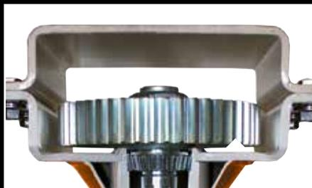
Colonne vertébrale de ces 3 modèles, le caisson est constitué de 2 demicouvercles boulonnés de 125 X 400 mm pour la PH1000, de 140 X 400 mm pour la PH2001 et de 150 X 400 mm pour la PH3000.
