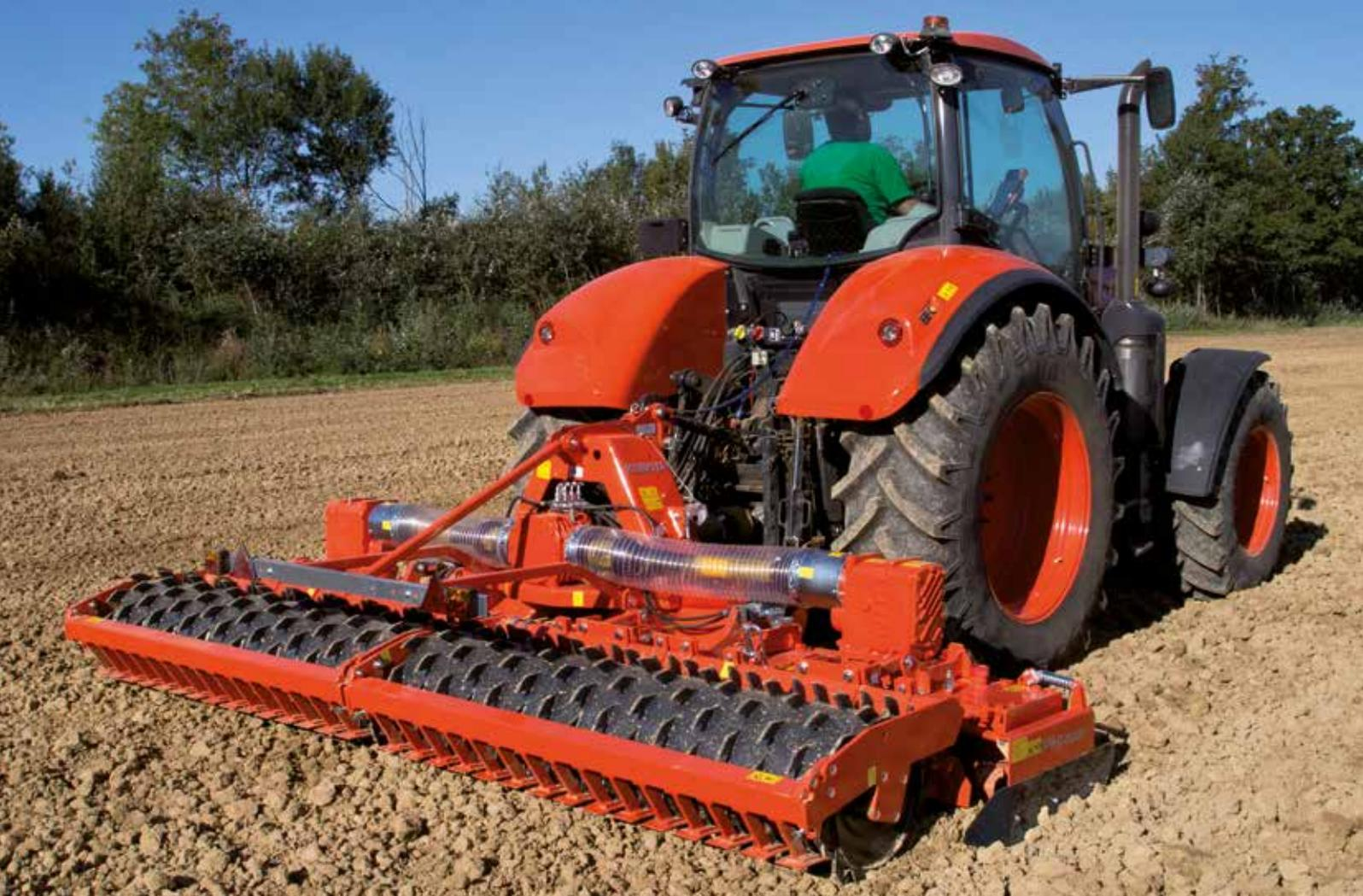
La herse rotative repliable Kubota FOLD PH1000F, adaptée aux tracteurs jusqu'à 200 CV, est l'outil idéal pour la préparation des lits de semence. Durant tout le développement, la fiabilité et la performance ont été les maîtres mots, en témoigne la robustesse du caisson, cependant une attention spéciale a été portée à la compacité. La FOLD PH1000F est disponible en 4,0 et 5,0 m et uniquement pour les utilisations en solo.
