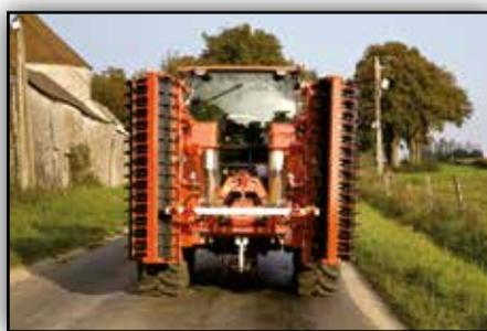
Toutes les herse repliables Kubota sont munies de boîtes de vitesses avec différentes vitesses de rotations des rotors (par levier ou pignons interchangeables). Chaque lamier est protégé individuellement de 1800 à 2200 Nm au limiteur de couple. La vitesse de rotation des rotors peut aller de 246 à 450 tr/min suivant les modèles PH1000F et PH2000F.
