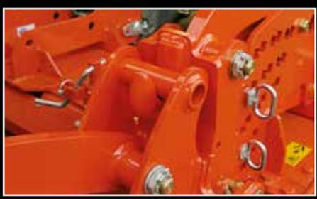
Les herse rotatives (PH2001 & PH3000) doivent être dotées du système d'accouplement « Euro-Connection » (un crochet d'attelage similaire à celui du chargeur frontal) afin de rapidement monter ou désaccoupler la rampe de semis. Par l'« Euro-Connection » la herse rotative est prête à l'opération solo en vitesse.
